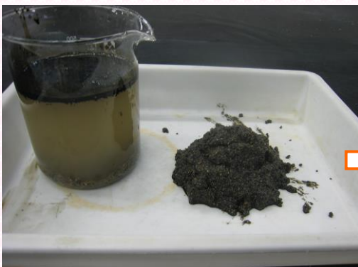
廃油を使用し模擬油汚染土壌を作成
