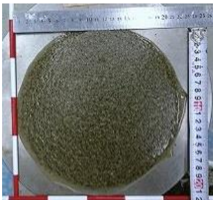
滞水砂質層掘削土
